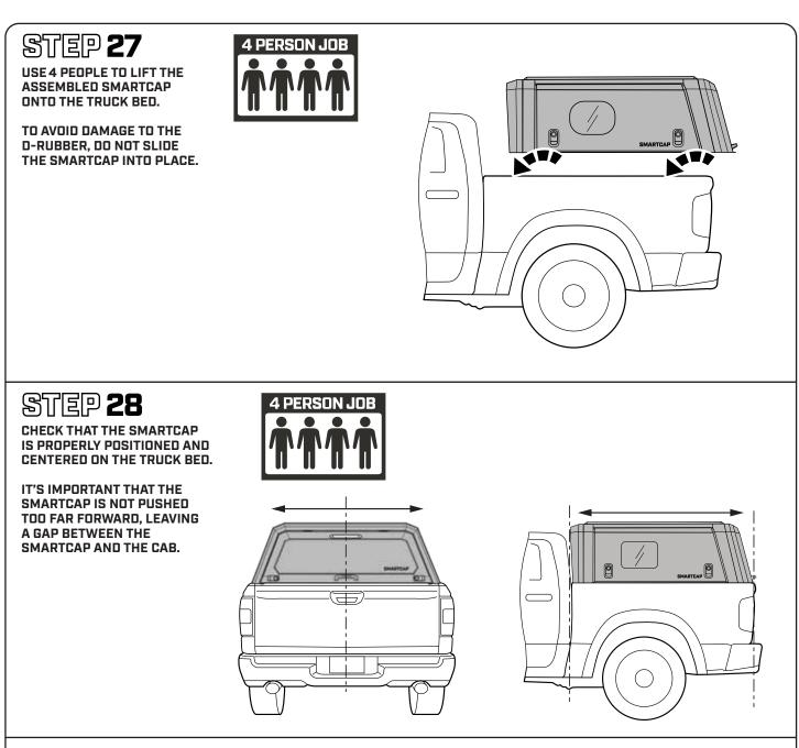
WALK AROUND THE TRUCK BED TO MAKE SURE THE D-RUBBER FITMENT IS CORRECT AND THAT THE RUBBER LIP IS PROPERLY TUCKED UNDERNEATH THE CAP.
